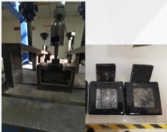
拉拔强度测试 1.3MPa
