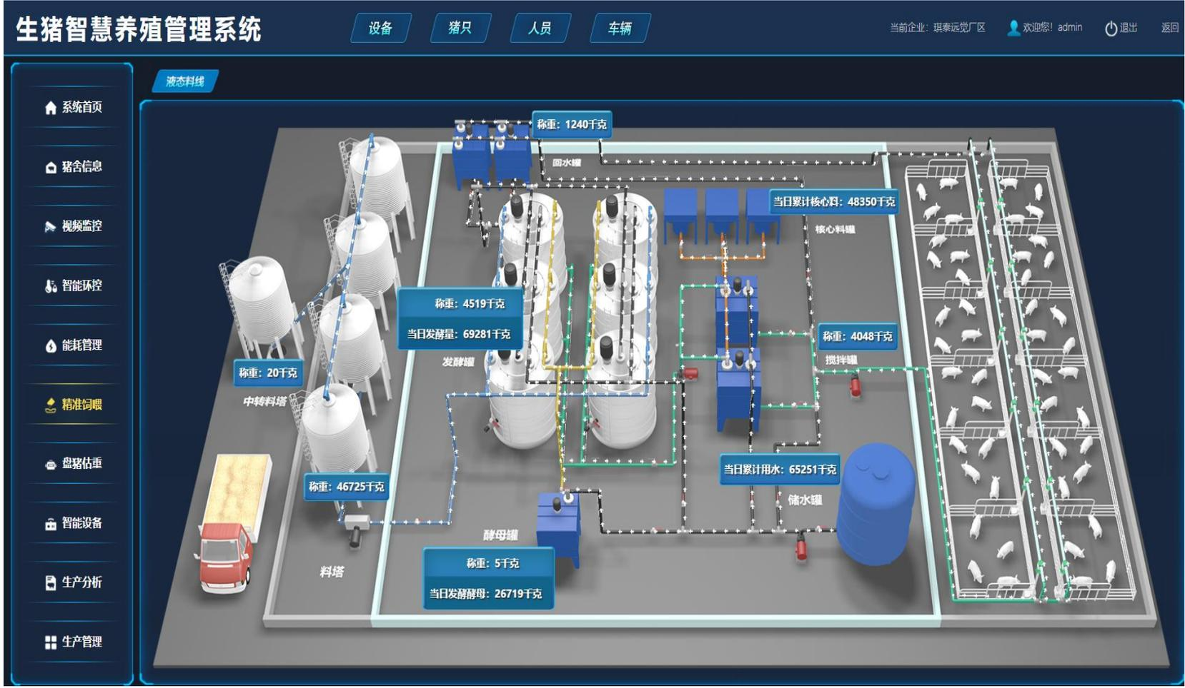
2.网络部分。以控制元件的集中控制为下层数据，通过以太网、EIA-485、Wi-Fi等接口接入控制中心或者IOT互联网平台。控制中心或者平台具备对饲喂控制系统远程控制、数据采集、数据对比及分析、数据存储。同时实现手机端的上述功能。
