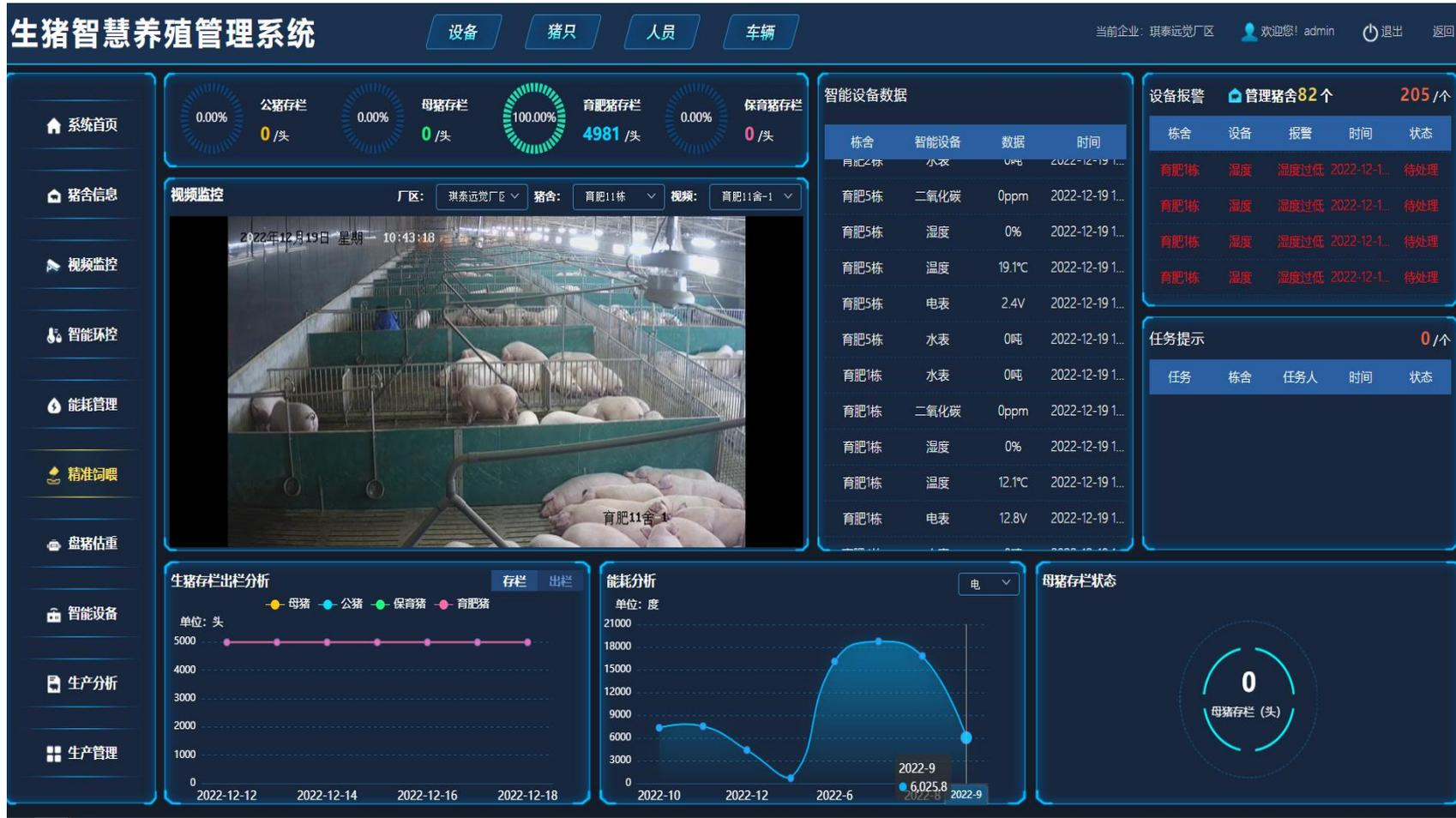
以猪场液态饲喂系统为载体，通过以太网链接中央控制设备，集成互联网、大数据等现代信息技术在生猪养殖领域的应用，实现对猪场液态饲喂过程的自动化控制和饲喂数据的采集、存储、分析与远程管理。
